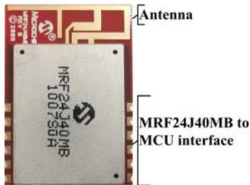
Fig. 2. MRF24J40MB Module
